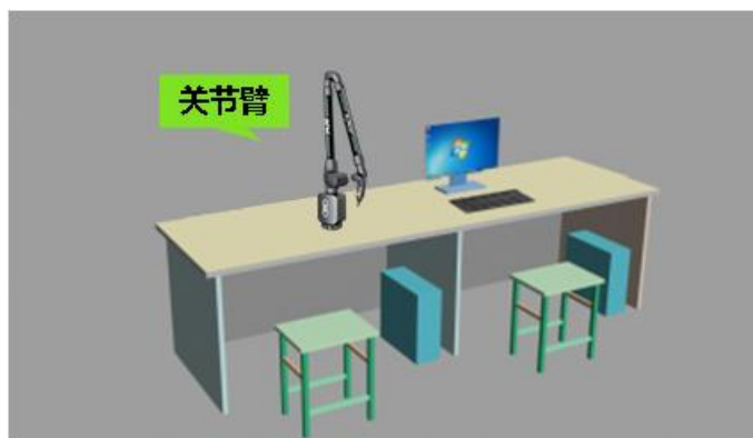
图 3 三维测量关节臂技术平台示意图
